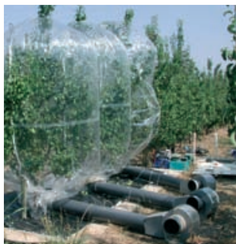
Control de l'intercanvi de gasos a nivell de planta en perer. Determinació dels nivells de fotosíntesi i de la transpiració.
